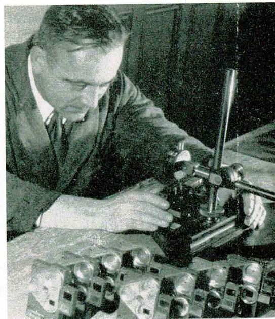
Première vérification du tirage mécanique de la caméra WEBO M.
