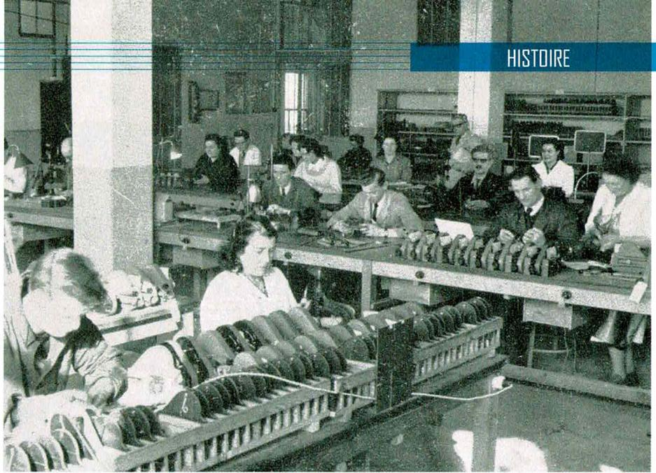
Comme dans toute fabrication importante, les différents ateliers montent des sous-ensembles qui étaient, après des contrôles sévères - contrôle mécanique, contrôle optique, - finalement assemblés. Puis les caméras passaient ensuite au contrôle de marche proprement (lit, qui comporte l'enregistrement d'un film-test qui est ensuite projeté pour la vérification du déroulement mécanique et du contrôle (le la couverture optique.
